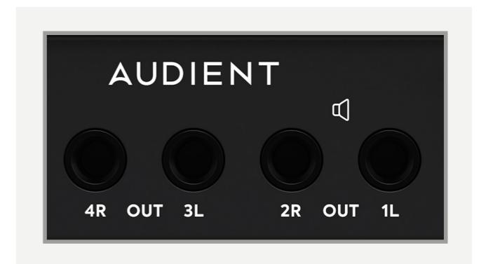
これらの出力はスピーカー以外にも使用できます。例えば、複数のミュージシャンで専用のヘッドフォンアンプを使用する場合、これらの出力の1つ、または複数に接続できます。この使用法はiDミキサー・ソフトウェアで設定できます。
