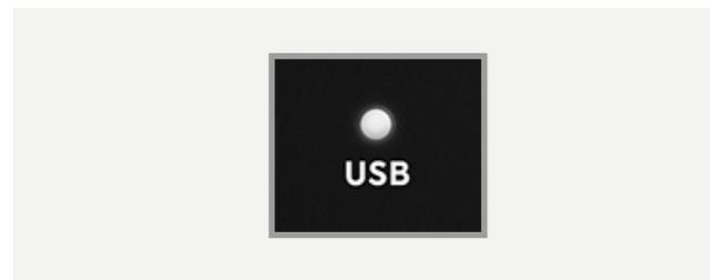
iD14が安定した通信を確立するとすぐにUSBステータスLEDが点灯し、電源を切るまで本体の動作中は点灯し続けます。
