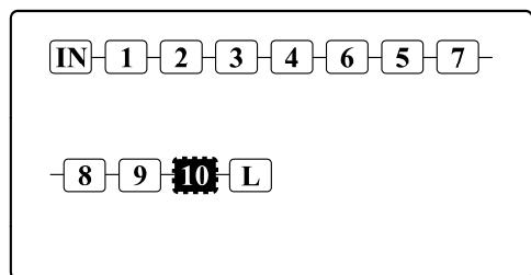
Loop10 を選択し、スイッチ #6 を長押ししてキャリーオーバーに設定します。
