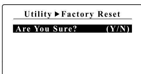
**SW#1** を 1 秒間長押しすると、工場出荷時設定へのリセットが開始されます。
