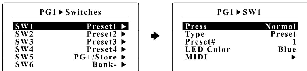
**Press** - 1 つのスイッチの押し方に応じて 2 つの機能が設定できます。
