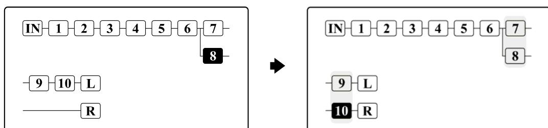
3. ループ8を選択し、スイッチ#4を押したままにして、下の行に移動します。
